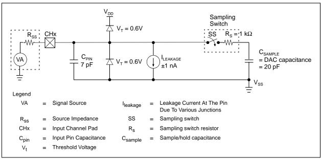
FIGURE 4-1: Analog Input Model.
