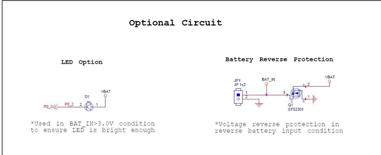
**FIGURE 2-5: BM71BLE01FC2 REFERENCE CIRCUIT**
