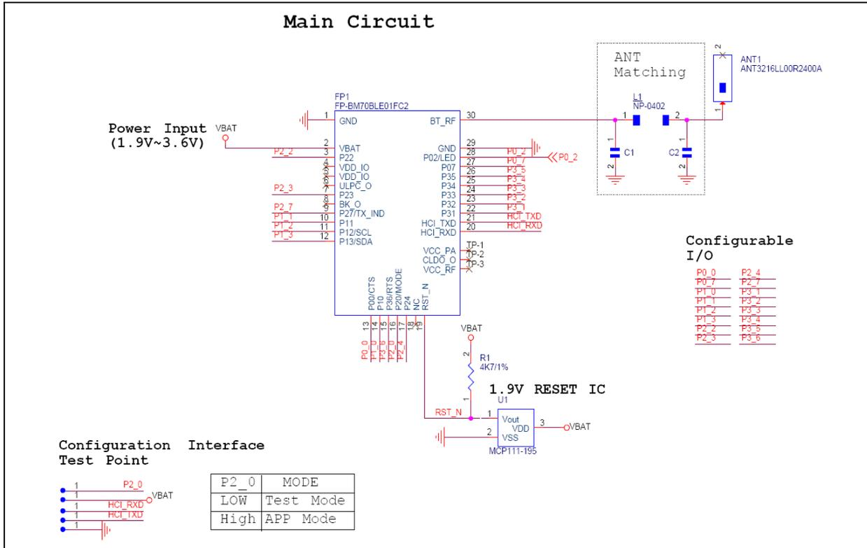
**FIGURE 2-4: BM70BLE01FC2 REFERENCE CIRCUIT**
